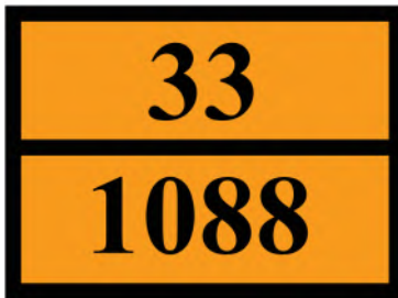
ป้ายสี่เหลี่ยมพร้อมที่มีหมายเลขแสดงความเป็นอันตราย และหมายเลขสหประชาชาติ
